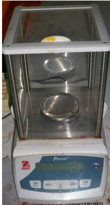
Gambar E.1 Neraca untuk menimbang aspirin, CMC dan ekstrak umbi teki
