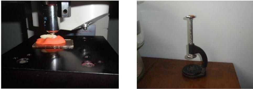
Gambar 3.5 Fiksasi sampel dan alat pengepress
