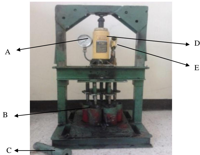
Gambar 3.1 Alat Cetak Briket : (A) Manometer, (B) Cetakan Briket, (C) Alat untuk Mengeluarkan Briket, (D) Hidrolik, (E) Tuas
