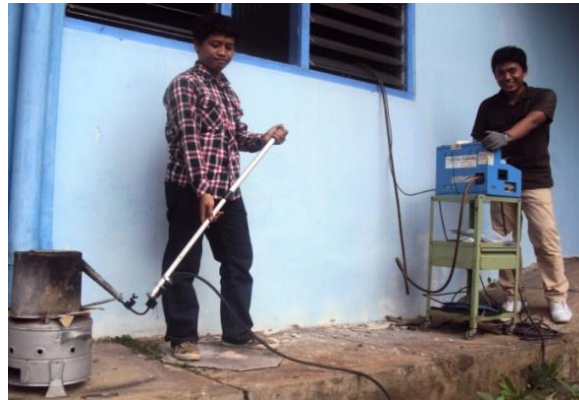
Uji Opasitas di UPT PKB Dinas Perhubungan Jember
