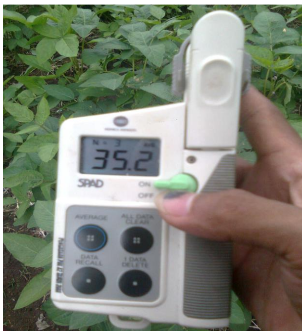
Gambar 19. Chlorophyll meter SPAD-502 Alat untuk mengukur klorofil Tanaman
