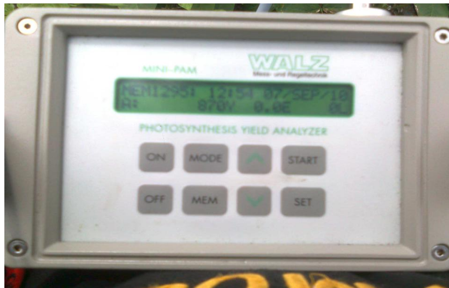
Gambar 21. Mini-PAM Alat untuk mengukur Laju Fotosintesis Tanaman
