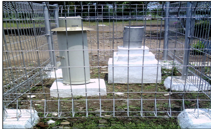
Gambar 3.2 Alat Pengukur Curah Hujan (Umbrometer) di Stasiun Pengamat Curah Hujan Curahmalang
