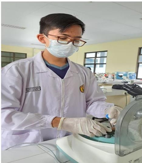
Gambar 7. Tabung conicel di masukkan ke dalam sentrifugal dan diputar dengan kecepatan 2000 RPM selama 3 menit, tahap ini diulangi sebanyak 3 kali
