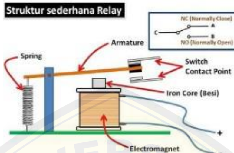
Gambar 2.4 Struktur sederhana relay (Sumber : Saleh dan Haryanti (2017))
