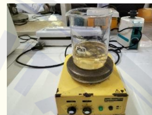
Mencampur minyak atsiri dan tween 80 dengan magnetik stirrer
