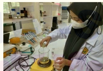
Mencampur minyak atsiri dan tween 80 dengan magnetik stirrer
