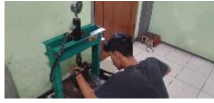
Densifikasi dan pencetakan briket bioarang
