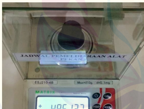
Penimbangan briket bioarang (kadar abu, laju, dan suhu pembakaran)
