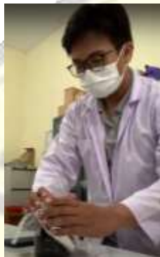
Aktivasi arang ampas tebu dengan NaOH selama 24 jam
