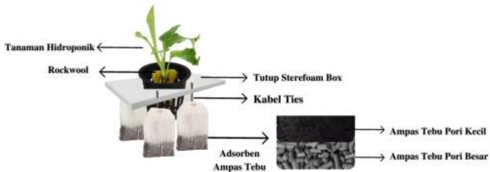
Gambar 4.1.2 Penempatan Adsorben dan Hidroponik Kangkung
