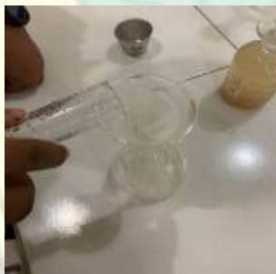
Pengujian TSS air limbah pada kertas saring
