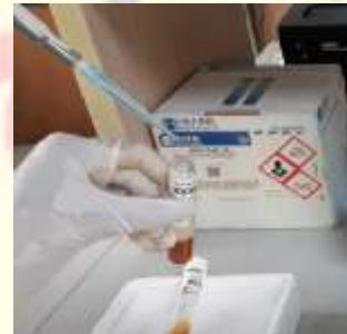
Penambahan air limbah pada COD reagent
