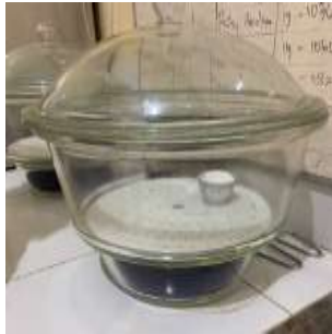
Pengeringan kedua kertas saring di desikator
