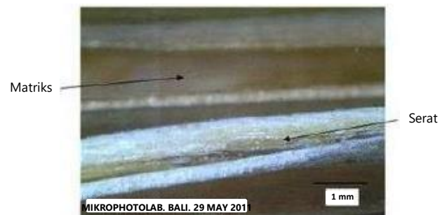
Gambar 4.7 Pengamatan mikro komposit arah serat 90^\circ (Sari, 2009)
