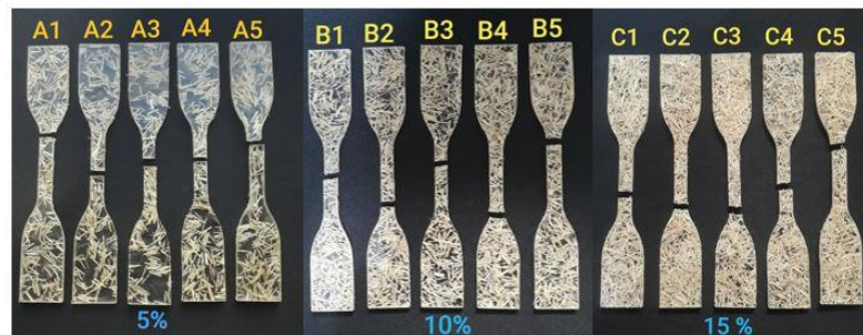
Gambar 4.2 (a) spesimen serat 5%; (b) spesimen serat 10%; (c) spesimen serat 15%
