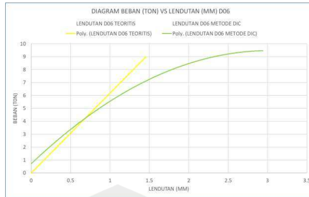
Gambar 4.4 Grafik Hasil Analisis Metode DIC Lendutan Benda Uji D06
