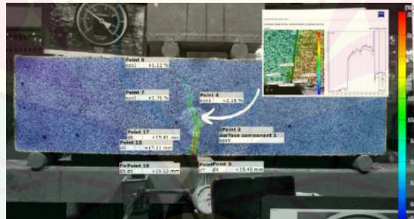
Gambar 4.28 Metode DIC Lebar Retak Benda Uji D10
