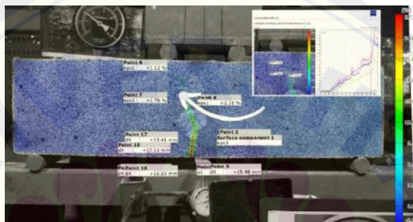
Gambar 4.18 Metode DIC Regangan Benda Uji D10
