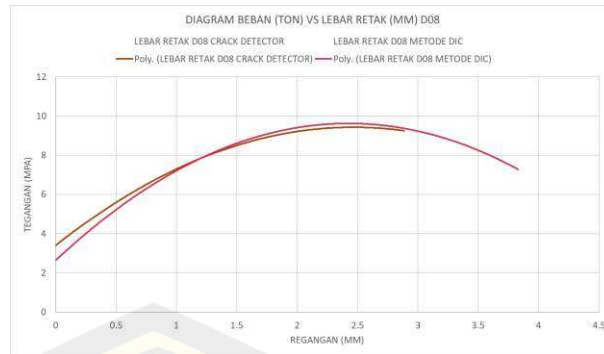
Gambar 4.38 Grafik Hubungan Beban dengan Lebar Retak Benda Uji D08
