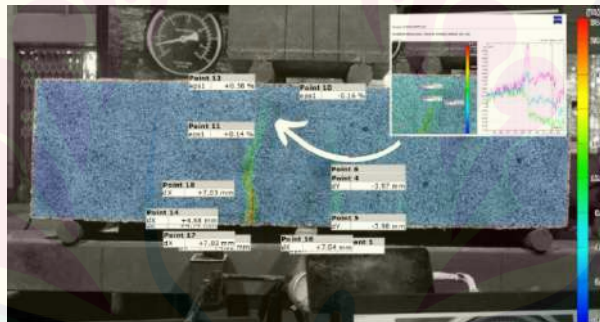
Gambar 4.11 Metode DIC Regangan Benda Uji D06
