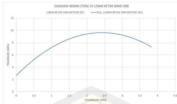
Gambar 4.27 Grafik Hasil Analisis Metode DIC Lebar Retak Benda Uji D08
