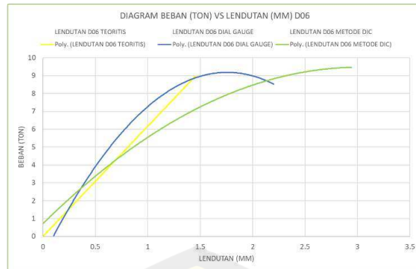
Gambar 4.31 Grafik Hubungan Beban dengan Lendutan Benda Uji D06
