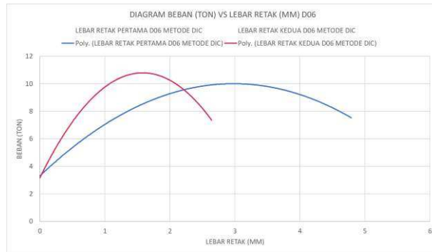
Gambar 4.24 Grafik Hasil Analisis Metode DIC Lebar Retak Benda Uji D06
