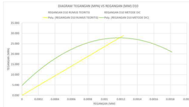
Gambar 4.20 Grafik Hasil Analisis Metode DIC Regangan Benda Uji D10
