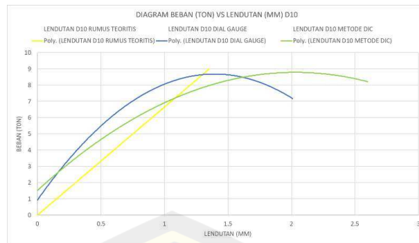
Gambar 4.33 Grafik Hubungan Beban dengan Lendutan Benda Uji D10
