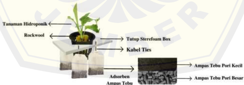
Gambar 4.1.2 Penempatan Adsorben dan Hidroponik Kangkung
