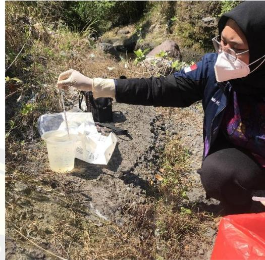
Gambar 6. Pengukuran suhu air di lapangan
