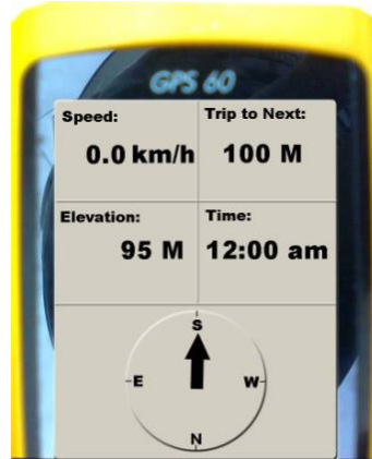
Gambar 3.2 Pengukuran jarak dan tinggi tanah (GPS Garmin tipe 60i)
