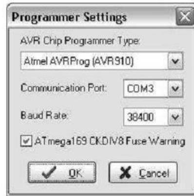
Gambar 3.19 Tampilan *Code Vision* pada *Wizard* saat Mengatur *Programmer setting*
