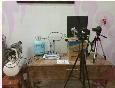
Gambar E.2 Instalasi pengambilan data visualisasi nyala api
