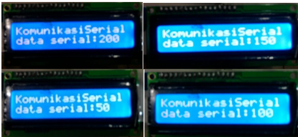
Gambar 4.13 Pengiriman data serial (a) data 50 (b) data 100 (c) data 150 (d) data 200.
