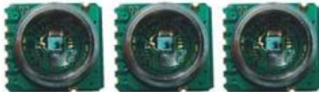
Gambar 2.7 Sensor Tekanan HP03SA (Sumber: datasheet HP03SA)
