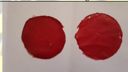
Edible film kitosan ekstrak - kulit buah naga merah
