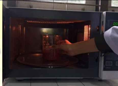
Ekstraksi bubuk kulit buah naga merah dengan metode MAE
