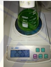
Gambar 4. Penimbangan larutan sebelum ekstraksi
