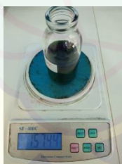
Gambar 7. Penimbangan larutan setelah ekstraksi
