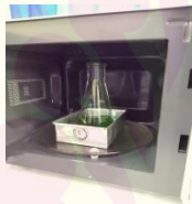
Gambar 5. Ekstraksi metode MAE
