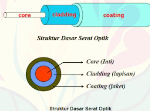
**Gambar 2.1** Struktur *Fiber Optic*
