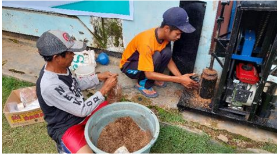
Gambar 4. Proses pemadatan baglog/media pertumbuhan jamur tiram F3 dengan menggunakan alat pengepres baglog 2 tuas
