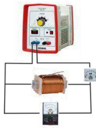
Diperoleh bahwa data pembacaan pada amperemeter merupakan nilai arus maksimum yaitu 0.2 A dan pembacaan voltmeter adalah tegangan maksimum = 10 V. Apabila kumparan dilepaskan dari rangkaian, kemudian hambatannya diukur dengan ohmmeter maka akan mendapatkan nilai hambatan 30  $\Omega$ . Dari semua data yang disebutkan, nilai reaktansi induktif kumparan adalah...
