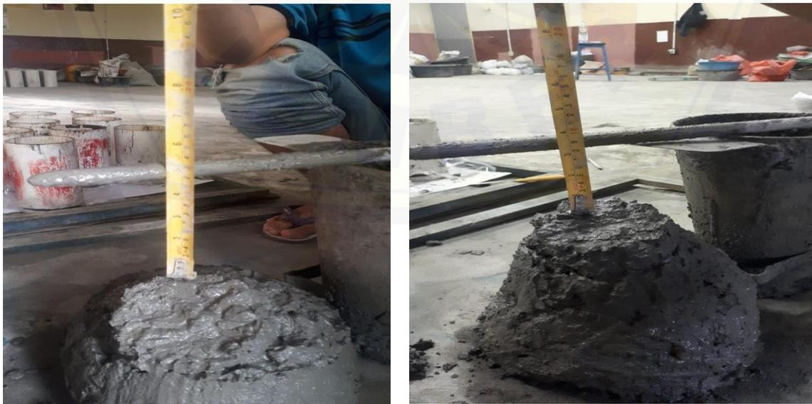
Gambar 4.3 Pengujian Slump
