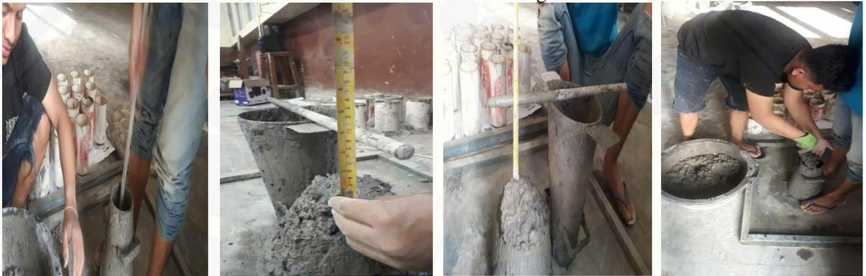
Lampiran B.6 Foto Pengujian Nilai Slump
