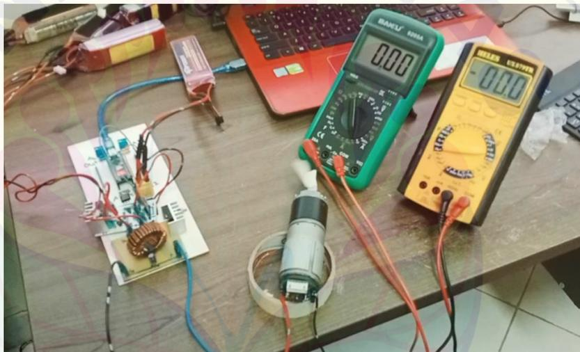
Gambar 4.7 Pengujian dengan Beban Motor
