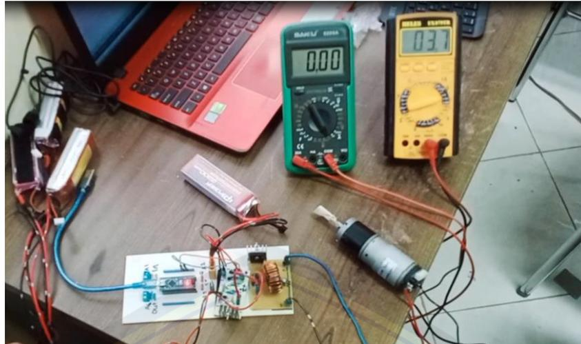
Gambar 4. Pengujian *Dc-Dc Buck Converter* Beban Motor
