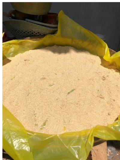
Gambar 6. Pengeringan Pasir Silika sebelum Proses Running Reaktor
