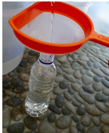
Gambar 3. 8 Pengambilan Sampel Air setelah Filtrasi
