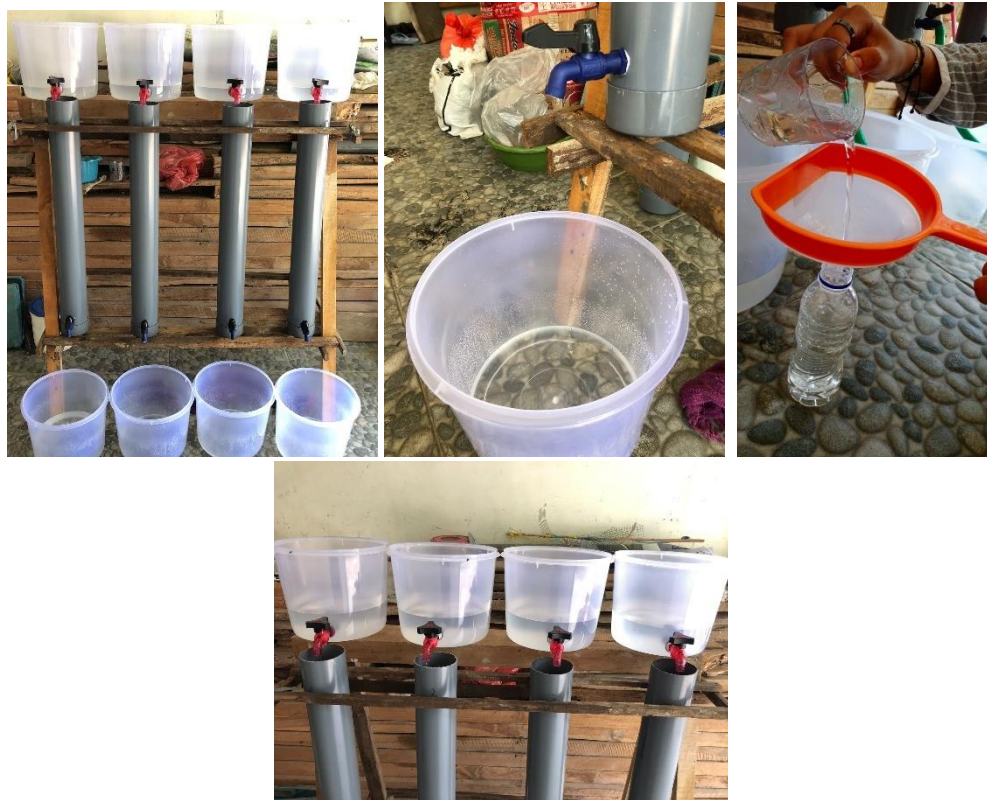
Gambar 9. Proses Running dan Pengambilan Sampel Akhir
