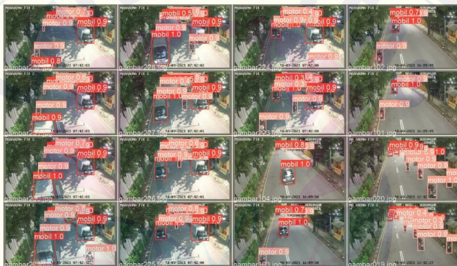
Gambar 3. 13 pengujian deteksi jenis kendaraan
