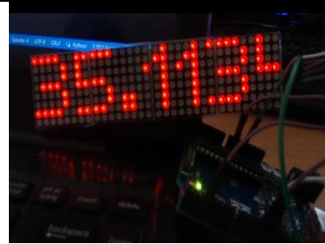
Gambar 4.32 Keluaran Running Text pada pengujian Ketiga
