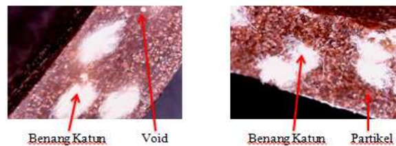
Gambar 7. Foto Mikro Orientasi Benang 55^{\circ}
