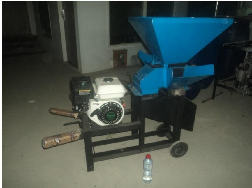
Gambar 4.1 Mesin Pencacah Rumput 3 Input 2 Output
