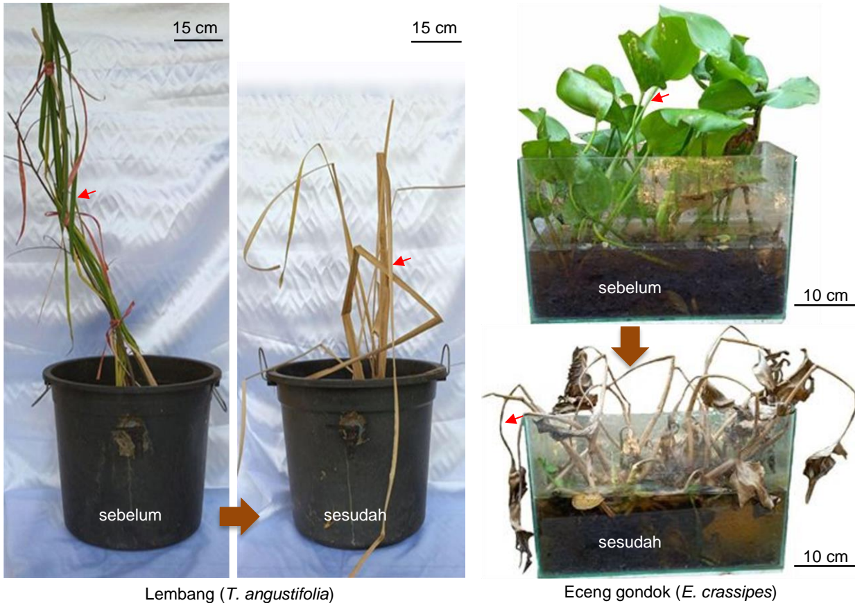
Gambar 3. Peubahan morfologi tanaman lembang dan eceng gondok sebelum dan sesudah digunakan pada fitoremediasi air limbah laboratorium
