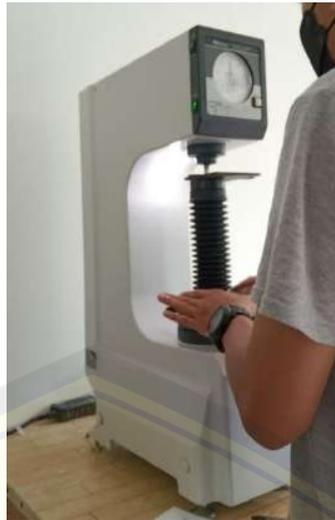
Gambar 2.11 Pengujian kekerasan menggunakan metode *Rockwell* (Sumber : Dokumentasi Pribadi)
