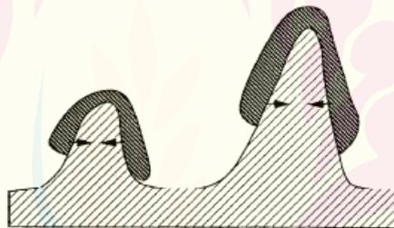
Gambar 2.9 Ilustrasi ikatan mekanik antara splat dan permukaan substrat yang tidak rata (Pawloski, 2008)
