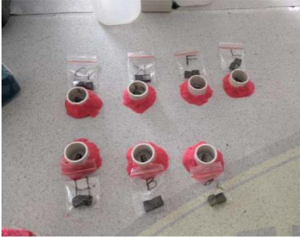
Proses Mounting Spesimen Uji Mikro
