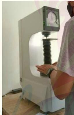
Gambar 3.5 Alat Uji Kekerasan (Sumber : Dokumentasi Pribadi)
