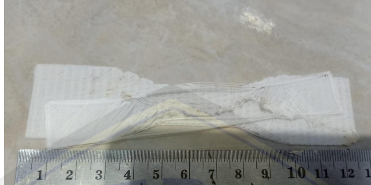
Gambar 4.4 Kegagalan cetak pada filamen ABS
