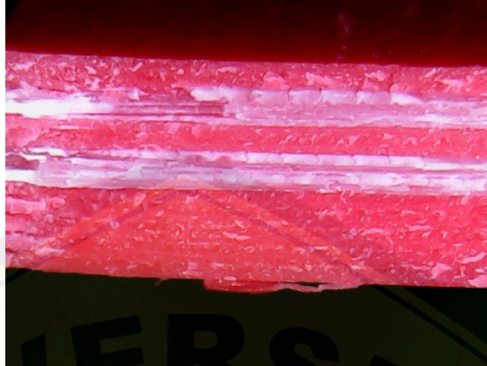
Gambar 4.20 Permukaan patahan pada infill 100%
