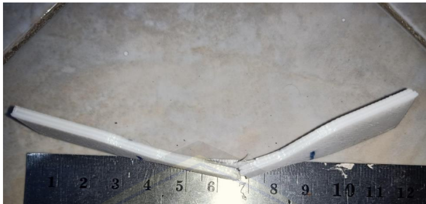
Gambar 4.10 Lapisan antara ABS dan PLA yang pecah dalam uji tarik
