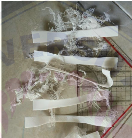
Gambar 4.2 Hasil Uji cetak filamen PLA dengan suhu alas 80^{\circ}\text{C}
