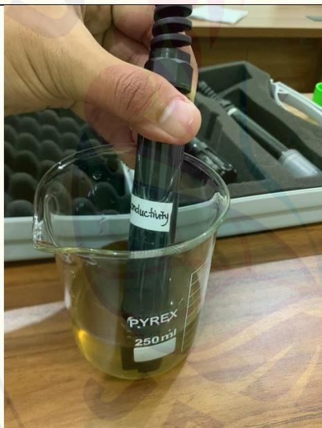
Menguji konduktivitas sampel air irigasi
