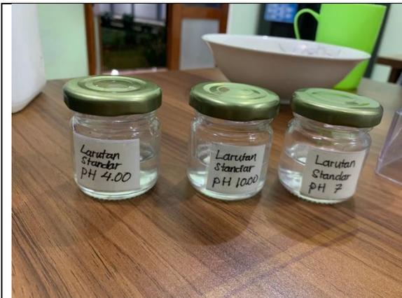
Larutan standar untuk mengkalibrasi pH
