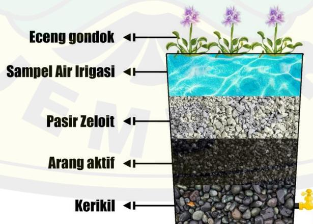
Gambar 3.3 Skema Reaktor K3 (Air irigasi, media penyaring, dan tanaman eceng gondok)
