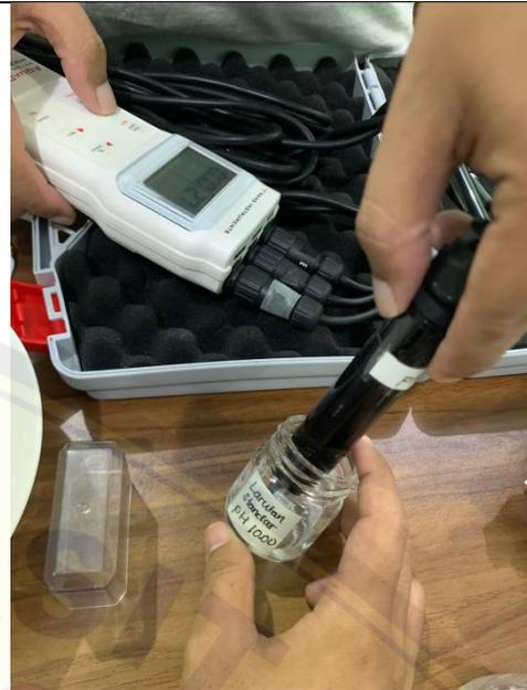
Kalibrasi pH pada *water quality meter* dengan menggunakan larutan standar
