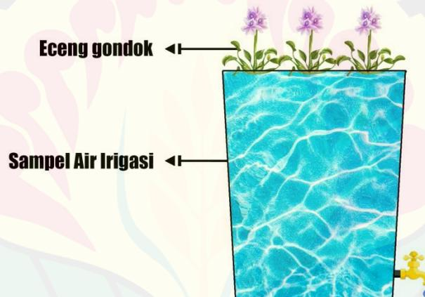
Gambar 3.2 Skema Reaktor K2 (Air irigasi dan tanaman eceng gondok)
