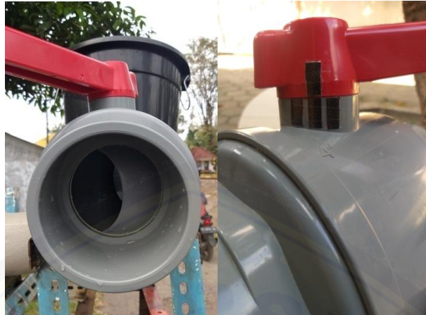
Gambar C6. Bukaan kran \frac{1}{2} (lebar 57 mm)
