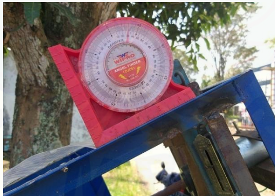
Gambar 4.2 Sudut kemiringan turbin (Yosy, 2021)
