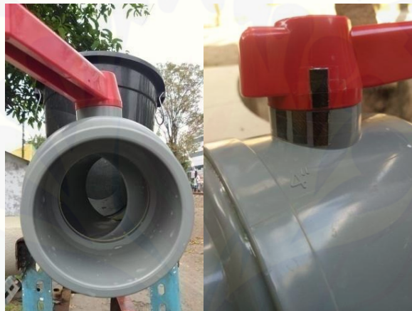
Gambar C7. Bukaan kran \frac{3}{4} (lebar 85 mm)
