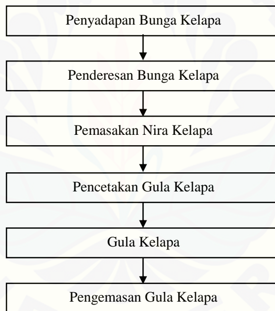
Gambar 4. 2 Tahapan Pembuatan Gula Kelapa
