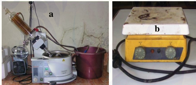
Gambar E.1.8 Alat Pembuatan Ekstrak dan Dosis; (a) Rotary Evaporator; (b) Kompor Listrik
