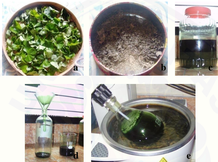
Gambar E.1.1 Bahan Pembuatan Ekstrak Daun Pegagan; (a) Daun pegagan; (b) Serbuk daun pegagan; (c) Proses maserasi; (d) Proses penyaringan; (e) Maserat yang sedang di Rotary Evaporatory;
