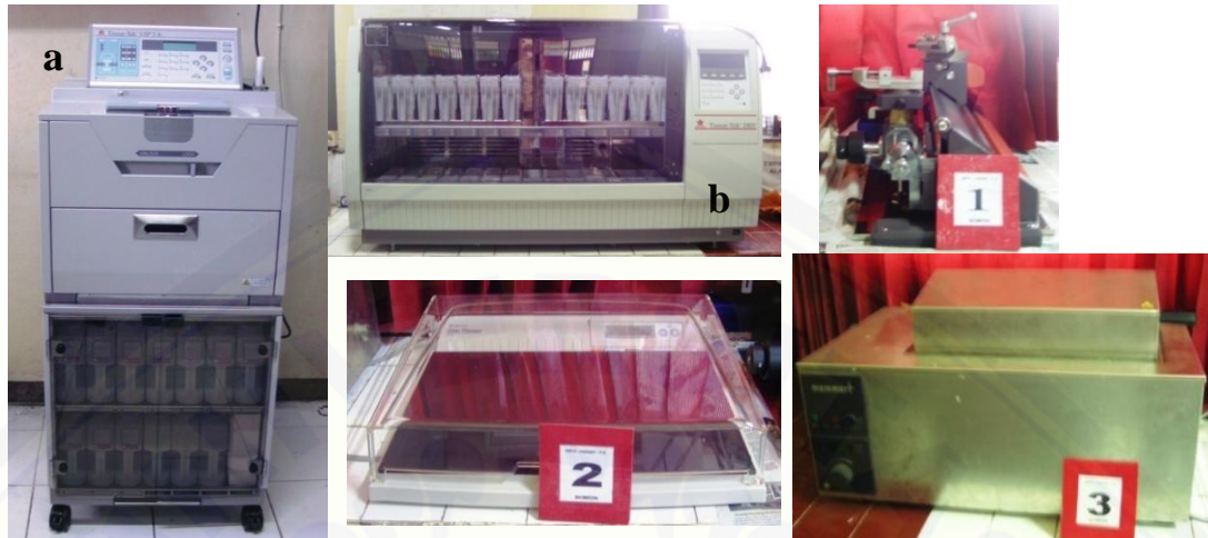
Gambar E.1.10 Alat Pembuatan Preparat Ovarium; (a)Alat Proses (Tissue-Tek VIP 5 JR); (b) Alat Pewarnaan (Tissue-Tek DRS); (1) Sliding Mikrotom (Yamato Japan); (2) Slide Warmer (Tissue-Tek); (3) Water Bath (Memmert)
