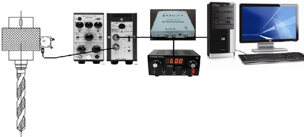
Gambar 3.3 Rangkaian alat uji getaran
