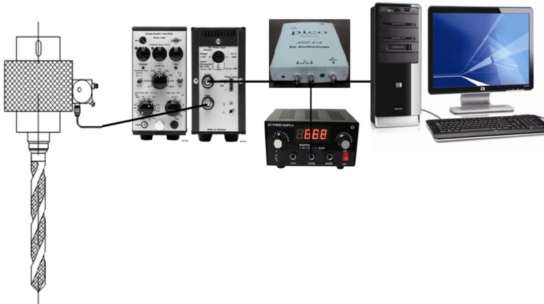
Gambar 2.10 Rangkaian alat uji getaran
