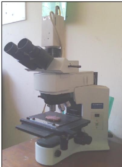
Gambar 3.5 Mikroskop Metalografi Olympus BX41M
