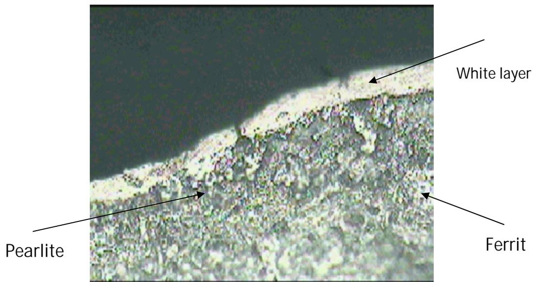
Gambar 4.4 Struktur mikro baja karbon rendah tipe AISI H-13 pada titik terdekat proses yaitu pada titik 5 proses EDM dengan arus 9 A dan on time 150  $\mu$ s pada pembesaran 500 X
