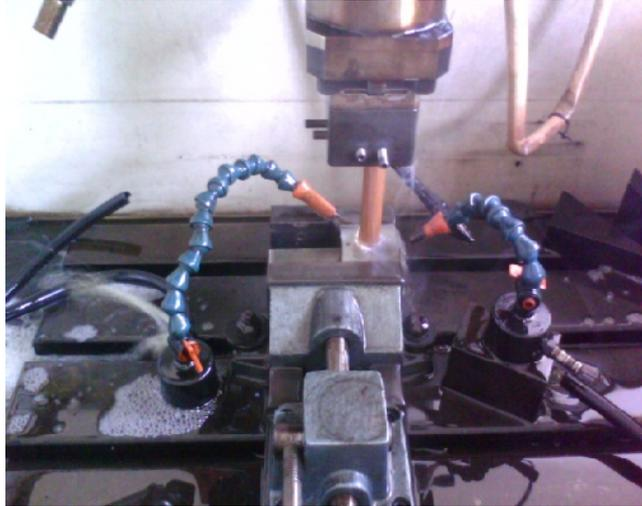
Gambar E.3 Proses pengerjaan benda kerja dengan mesin EDM *Die Sinking*
