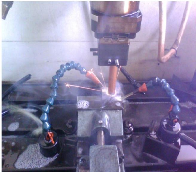
Gambar E.4 Proses pengerjaan benda kerja dengan mesin EDM *Die Sinking*
