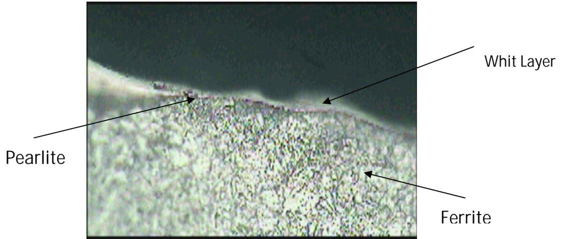
Gambar F.1 Struktur mikro baja karbon rendah tipe AISI H-13 pada titik terdekat proses yaitu pada titik 5 proses EDM dengan arus 6 A dan *on time* 90  $\mu$ s pada pembesaran 500 X
