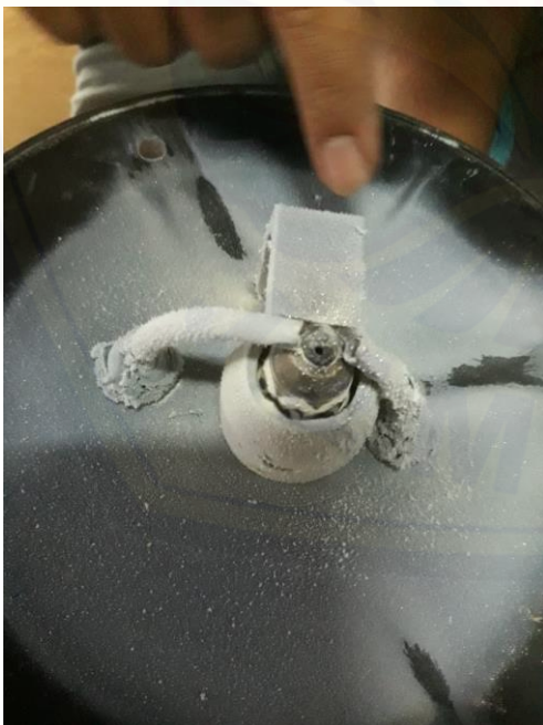
Gambar partikel nano alumina pada piringan nozzle plasma
