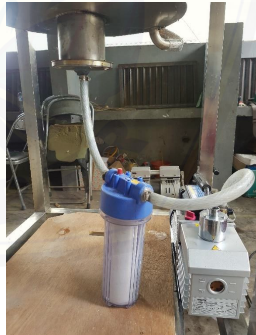
Proses vakum (menghisap nanopartikel yang terbentuk)
