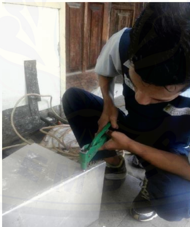
Gambar C. 10 Proses Perivetan Untuk Pembuatan Hooper
