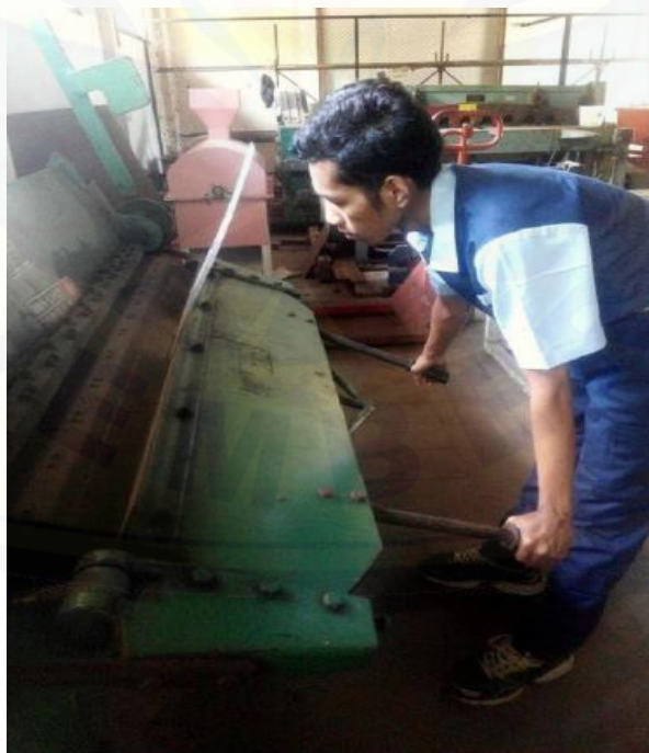
Gambar C.8 Penekukan Plat Untuk Hooper
