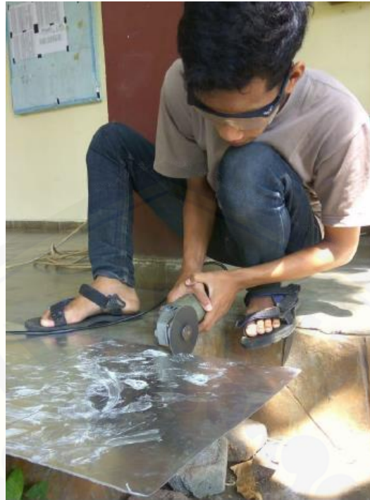
Gambar C. 7 Pemotongan Plat Untuk Hooper
