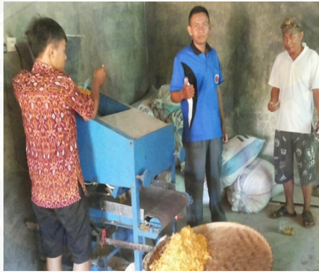
Gambar 2.3. Mesin Pemipih jagung (Sumber: Agus daryat, 2015)
