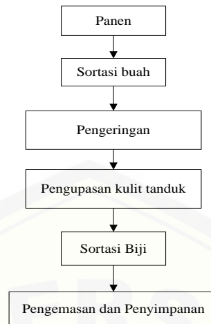
Gambar 2. 7 Tahapan pengolahan kopi secara kering Sumber: Permentan No.52 (2012)
