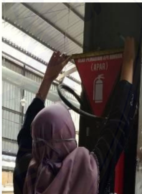
Gambar 8. Pengukuran tanda APAR (Tanda APAR bukan segitiga sama sisi dengan ukuran < 35 cm
