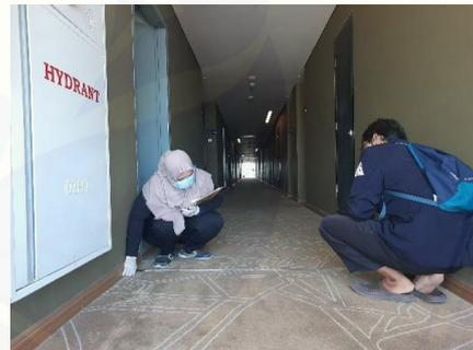
Gambar 12. Pengukuran Lebar Koridor sebagai Akses Jalan Keluar
