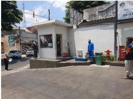
Gambar 5. Proses Pengukuran Jarak Hidran Halaman dengan Akses Jalan Umum
