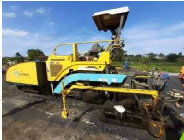
Gambar 2.3 Alat Berat Asphalt Finisher (Sumber : Dokumentasi Pribadi)
