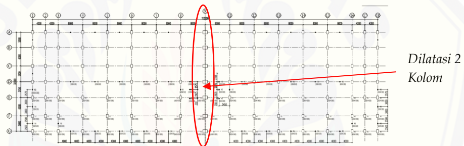
Gambar 3.3 Denah Gedung Parkir bertingkat Universitas Airlangga Kampus B dengan dilatasi 2 kolom.
