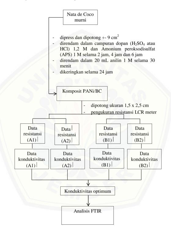
Gambar 3.2 Diagram Alir Sintesis Komposit PANi/BC
