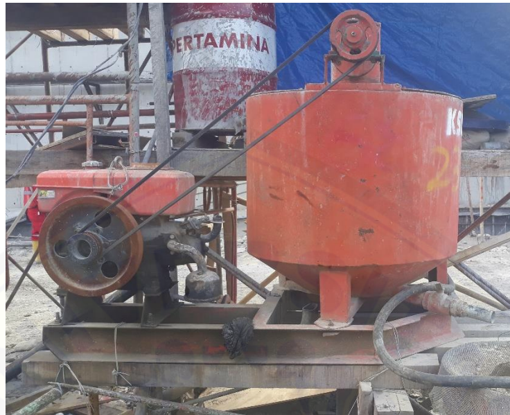
Gambar 2.23 Grout Mixer dan mesin diesel
