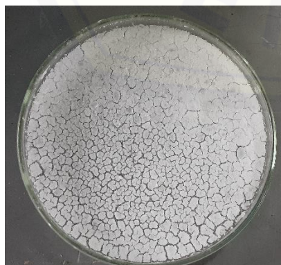
Padatan kering setelah proses pencucian dan pengovenan Kembali, sebelum dikalsinasi
